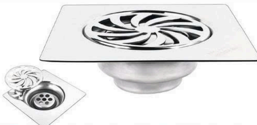
Phễu thoát sàn lọc rác, chống mùi và côn trùng phù hợp với đường ống từ Ø60 → Ø110
