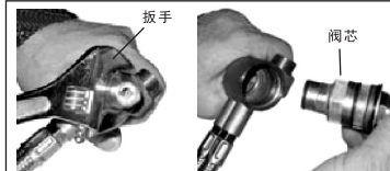
3.用扳手将阀芯旋开，取出阀芯；
