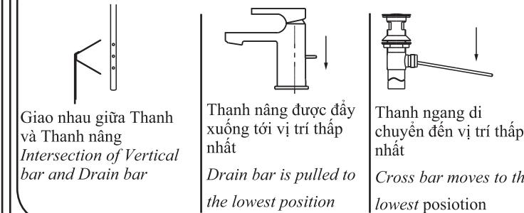
d. Điều chỉnh sau khi lắp đặt: Điều chỉnh tăng độ cao của Thanh nâng
