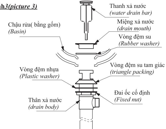
b. Lắp đặt Thanh ngang: Tham khảo hình 4, nối Ông xả nước và phần Thân xả nước lại với nhau, sau đó vặn chặt cố định. Tiếp theo lắp Thanh xả nước vào trong Thân xả nước. Lắp Vòng chịu ma sát và O-ring vào đoạn ngắn của Thanh ngang rồi lắp vào Thân xả nước, đồng thời lắp vào lỗ của Thân xả nước. Bên đầu còn lại của Thanh ngang lắp Vòng chịu ma sát vào và vặn chặt Dai ốc cố định.
