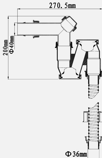
• Kích thước đường ống: DN40 (40 mm)
