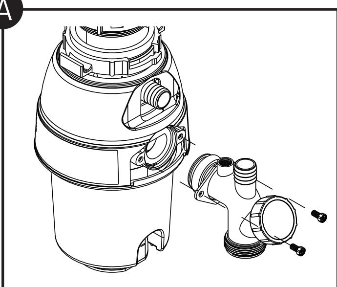
将排水弯管接到处理器上 (见图 A) 拧 紧螺丝。
