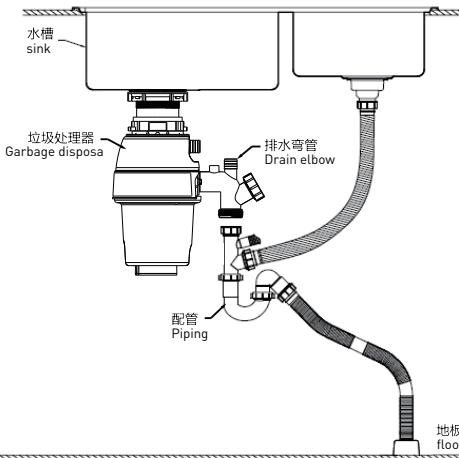
按照示意图，用连接套将摩恩双槽管连接到垃圾处理器。
