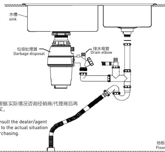
按照示意图重新组装配管（去掉部分多余的零件）
