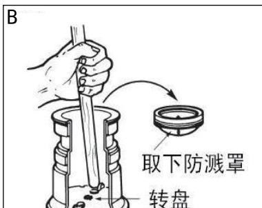
此时应关闭电源，待处理器完全停止后，取下防溅罩，用长柄工具拨动转取出异物（见示图B），再盖回防溅罩。如果没有异物，就可能是机器内部的问题，需要与分销商联系修理或更换。                                                                                                                                                                                                                    |
