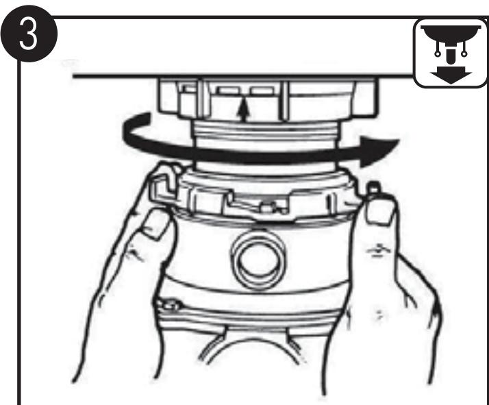
向右转动装配环，直至拧紧。处理器的卡锁拧入装配环最左端卡锁槽内。
