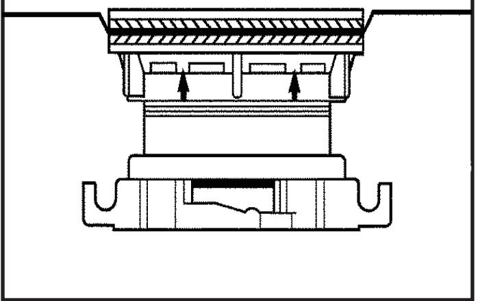
弹性垫圈装好后，可将装配环放下，盖住弹性垫圈并可以轻松转动。
