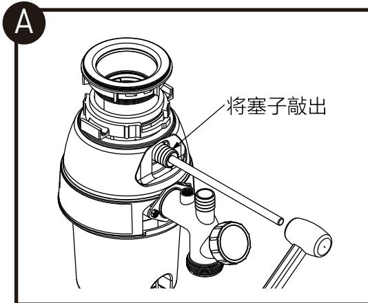
如果您使用洗碗机, 请按照左图指示进行连接。如果不连接洗碗机则继续下一步安装。用一个钝的工具 (钳子或木棍) 敲掉处理器的塞子 (见图 A)。不要使用螺丝刀或其他较为锋利的工具。当敲下的塞子 落入处理器时, 您可取出, 或当处理器工作时将其搅碎。不会 对处理器产生任何损害。只需将洗碗机的软管同处理器的洗碗机接口相连接即可。按图示方向拉出塞子, 只需将洗碗机的软管同处理器的洗碗机接口相连接即可 (见图A)。
