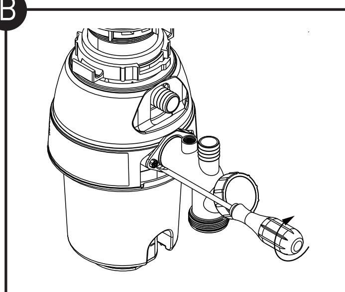
确认所有的管件已接连牢固。(见图B)
