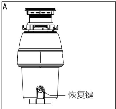
关闭电源，取出防溅罩，用长柄工具拨动转盘，查看是否转动自如。如果转盘转动自如，盖回防溅罩，再查看“热保护器复位按钮”是否弹出，“热保护器复位按钮”是红色的，在电源线引出端的正背面，接近底座位置，使用类似于筷子粗细的木棒可以直接触碰到（见示图A），如弹出将其按下即可复位，然后再接通电源启动（可能存在复位按钮无法即时按下的现象，这是电机过热，保护器还处于保护状态，正常情况下间隔30分钟以后，可以按下复位按钮）。如果“热保护器复位按钮”未弹出，请检查处理器的连接电源线，或电源开关、保险闸门、电源断合器等。如果电源线连接和电器部分都完好，有可能是处理器内部的问题，需要与分销商联系修理或更换。 |
