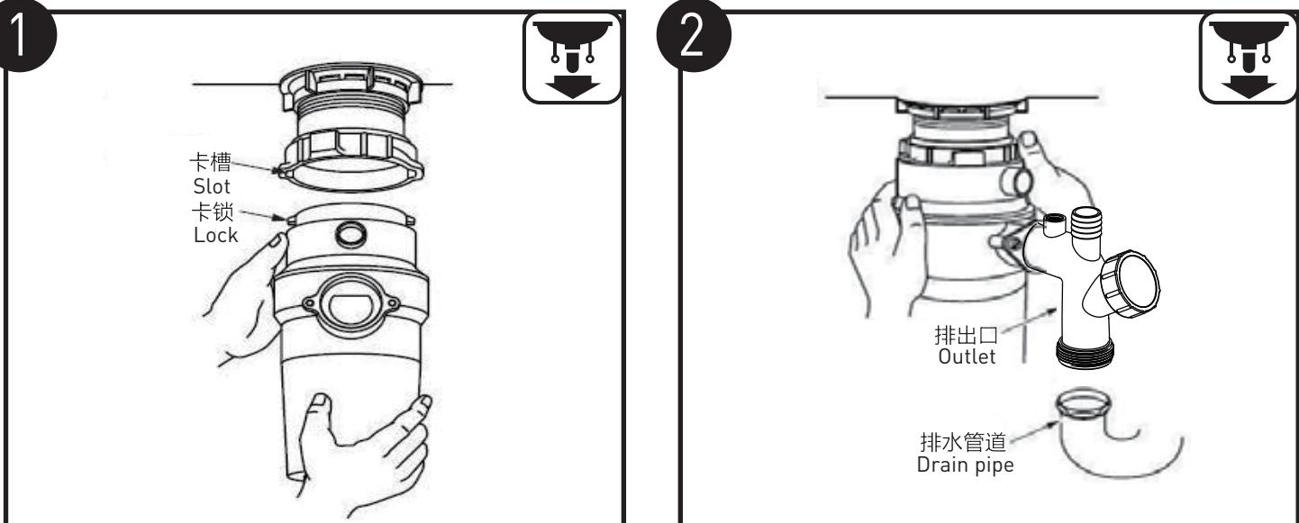
将处理器对准固定装置的下端，再将处理器的卡锁插入装配环，向右转动装配环大约 6mm，使处理器暂时卡住。
