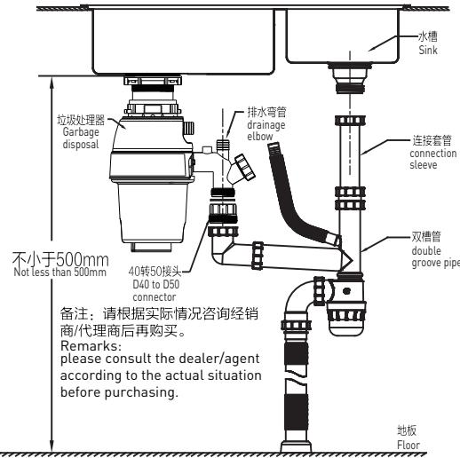
垃圾处理器的出水管可直接连接摩恩落水配管。
