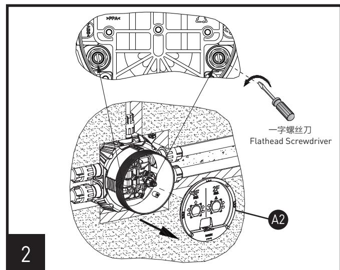
取下预埋盒保护盖 (A2) 对管路进行密封测试。开启总阀后逆时针打开两个止逆阀通入水压，压力值范围为0.8~2.5MPa，建议1.2MPa。观察阀体内部，保持稳定压力1~3分钟，无漏水现象后再顺时针关闭两个止逆阀，盖上保护盖。
