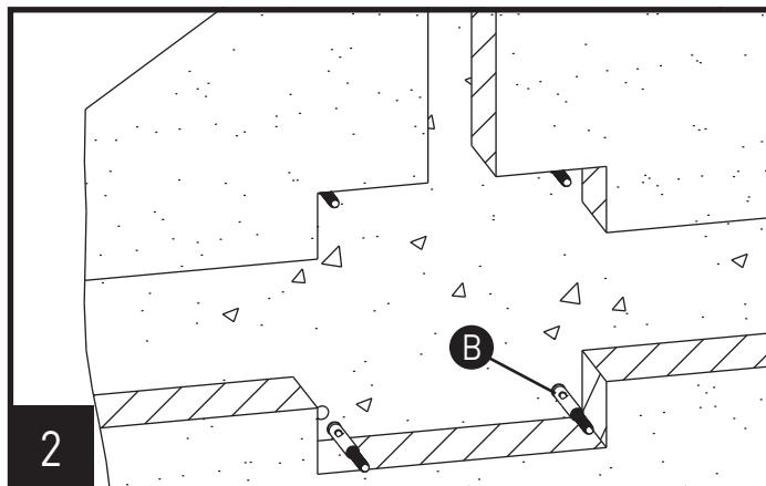
用记号笔画出四个孔的位置，并用电钻打出四个深度约40mm  $\phi$  8的孔。
