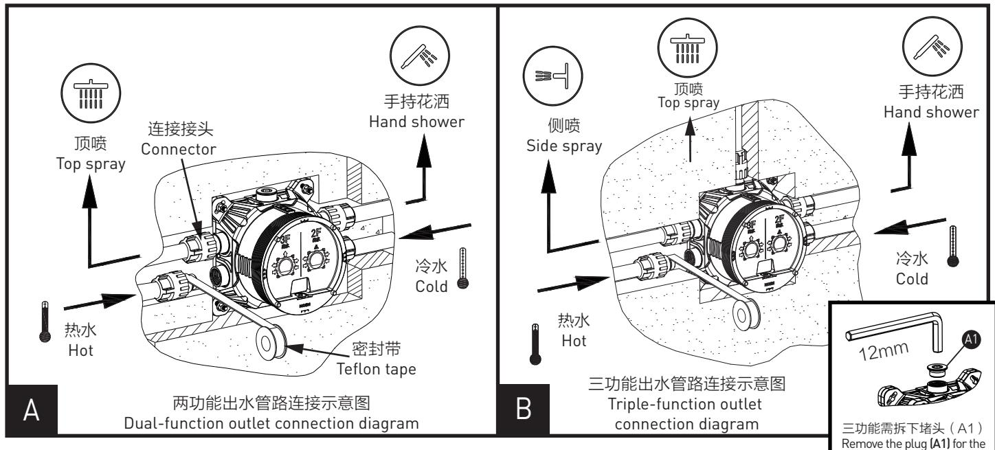
接头连接处需缠上密封带并按图示要求连接管路。注：1. 两功能中间水路水管在出厂时已封闭；
