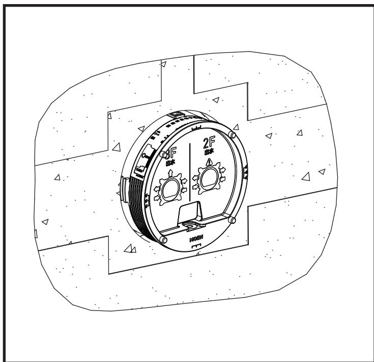
填充壳体周围空隙至平齐毛坯墙面。
