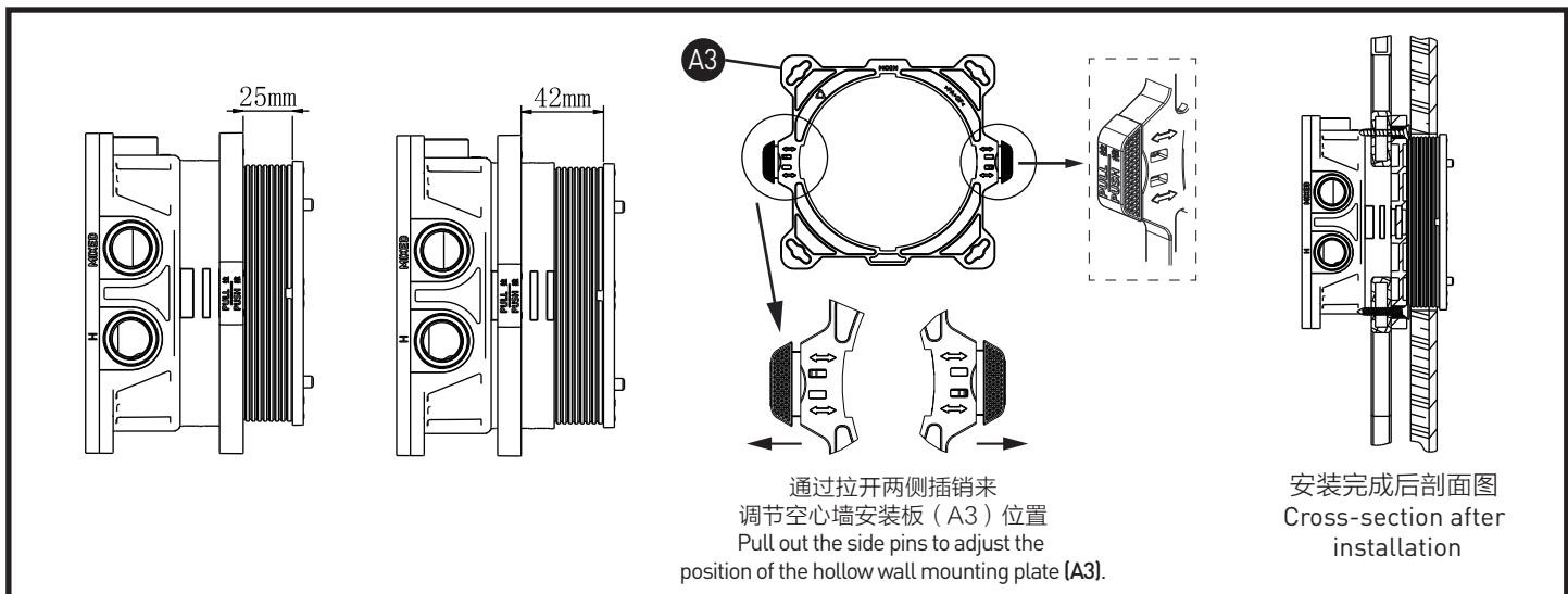
根据不同空心墙厚度，调整好空心墙安装板 (A3) 的距离，如图 (25mm~42mm)。
