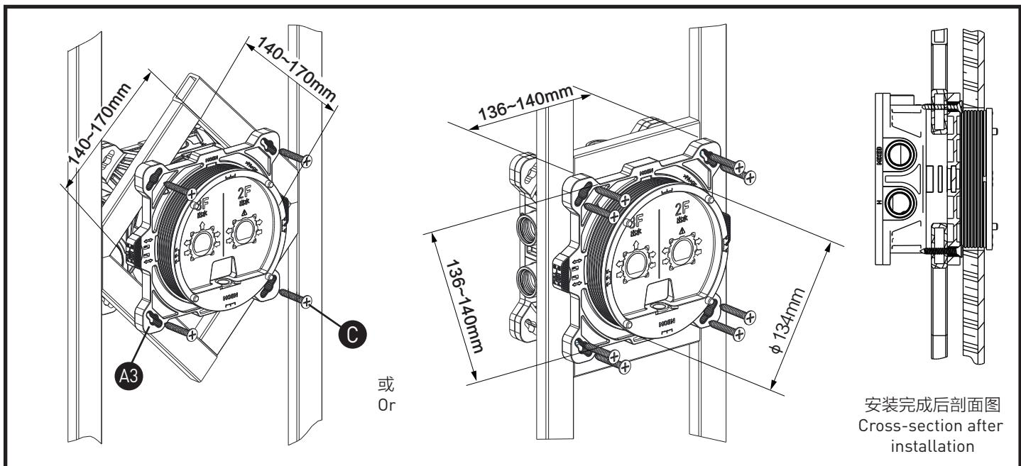
如图制作固定架，并用自攻螺丝 (C) 通过空心墙安装板 (A3) 将预埋盒固定在架子上。
