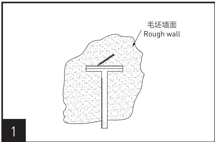
在毛坯墙上标定安装固定预埋盒的位置。
