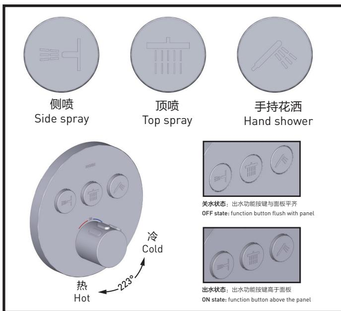
按下童锁并逆时针旋转手轮为热水模式，反之冷水模式；
