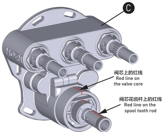
恒温阀芯在出厂时已进行全检测温。转动阀芯花齿杆确保杆上的红线与阀芯上的红线对齐（一般红线画在正上方）。
