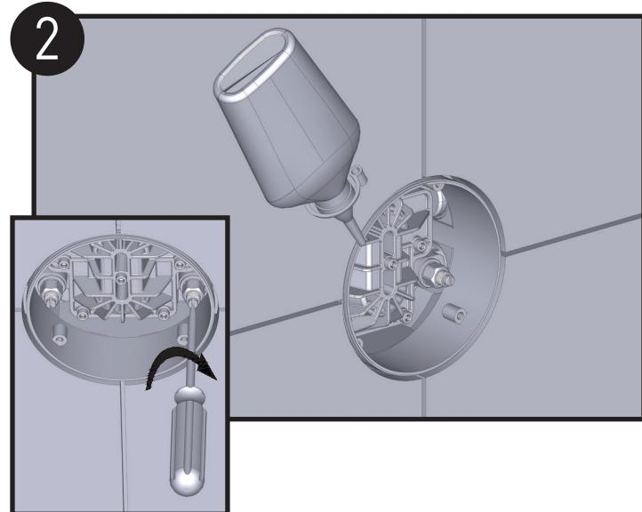
用防水密封胶完全填充墙面开口与塑料壳体之间的空隙，并使用一字螺丝刀顺时针拧紧左右两个止逆阀至关闭状态。
