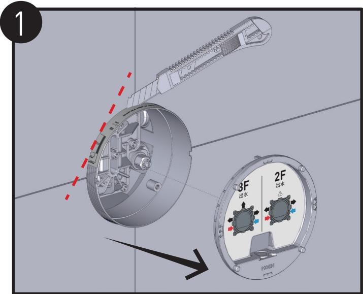
取下预埋盒保护盖，用剪线钳或美工刀将高出墙面的塑料壳体去除直至平齐墙面。
