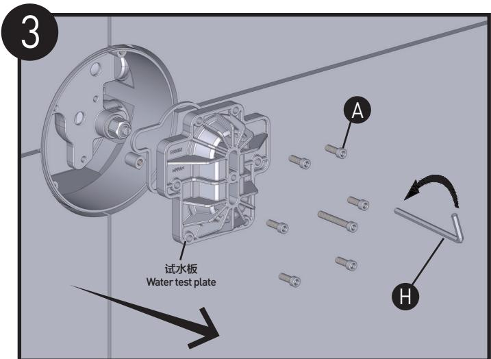
用4mm六角扳手 (H) 拧松螺丝 (A) , 拆下试水板。
