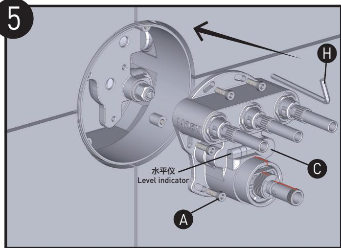
将恒温阀体组件 (C) 固定到预埋盒内。将恒温阀体组件 (C) 上的水平仪调至水平并用4mm六角扳手 (H) 拧紧螺丝 (A) 将其固定。**注：**此阀体支持左右歪斜可调整的角度为 $\pm 5^\circ$ 。
