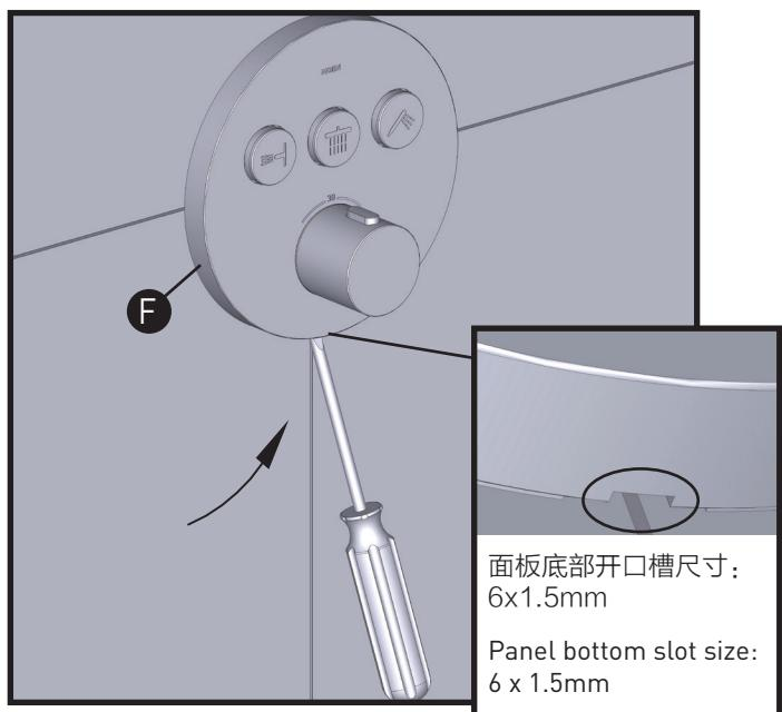
使用一字螺丝刀对准面板底部的开口槽旋转一圈可将
