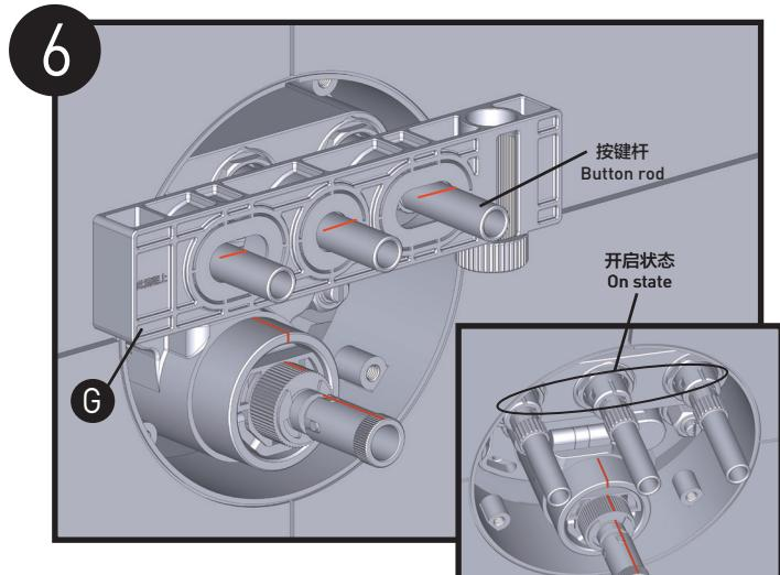
将调节尺 (G) 对准按键杆紧贴在瓷砖墙面上，用记号笔在按键杆上画出平齐于调节尺 (G) 平面的记号。
