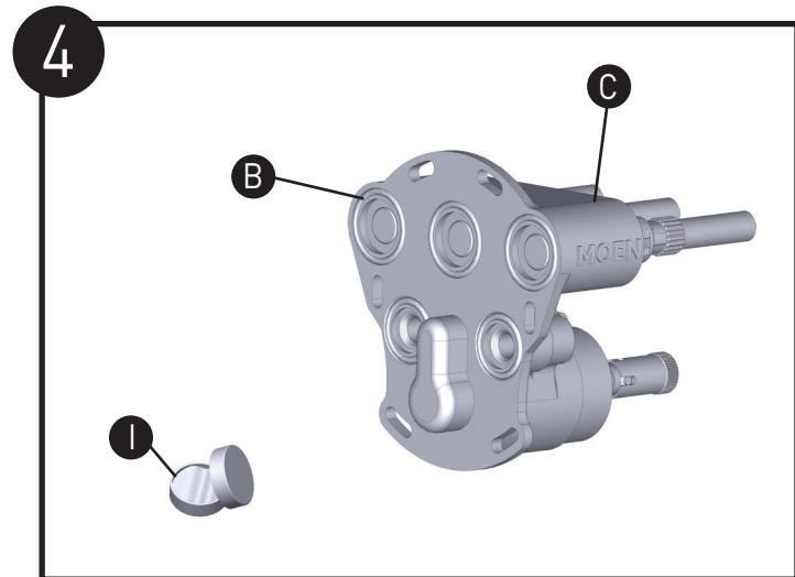
用硅脂 (I) 涂抹在恒温阀体组件 (C) 底部密封O型圈 (B) 上。
