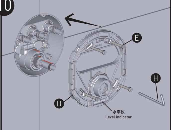
将恒温连接板组件 (D) 上的水平仪调至水平并按图示使用4mm六角扳手 (H) 拧紧螺丝 (E) 将其固定。
