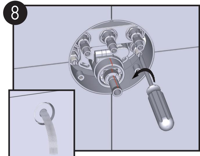
用一字螺丝刀逆时针松开预埋盒上的左右两个止逆阀通水，并查看管道通水情况。
