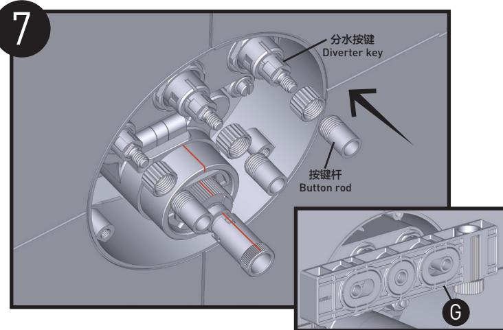
将按键杆拆下并裁切掉多余的部分，再将其拧紧回分水按键上，最后再用调节尺 (G) 核对高度是否正确。
