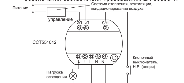
Рис. 7. Схема подключения для типичной области применения с двойной нагрузкой
