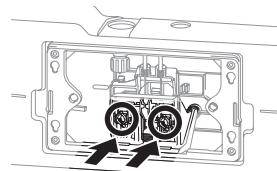
Đóng van ngắt nước trong két nước và nhấn nút trên thiết bị truyền động để xả nước.
