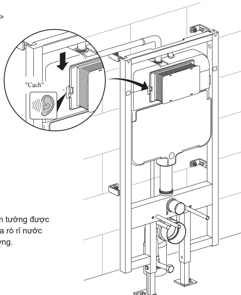
⚠ Đặc biệt lưu ý: Sau khi két nước âm tường được cố định hoàn toàn, cần phải kiểm tra rò rỉ nước trong vòng 12 giờ trước khi xây tường.
