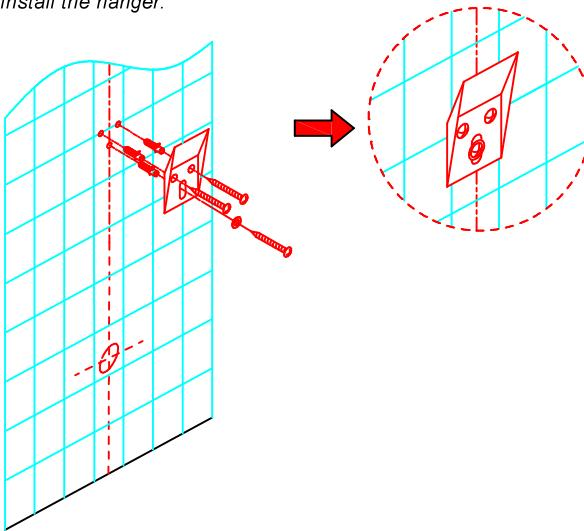
3. Lắp đặt bích nối tường./ Install the wall flange.
