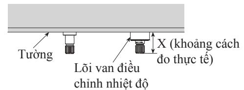
5. Dựa theo giá trị đo thực tế  $X \pm 1\text{mm}$  ở bước 4 để cắt trực nối dài. (2 cái)
