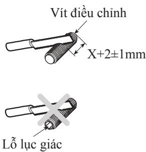
14. Vặn thanh vít điều chỉnh đã cắt ở bước 13 vào thanh trượt nút nhấn.
